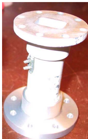
Umgebauter Technisat-Polarizer mit Flansch.
