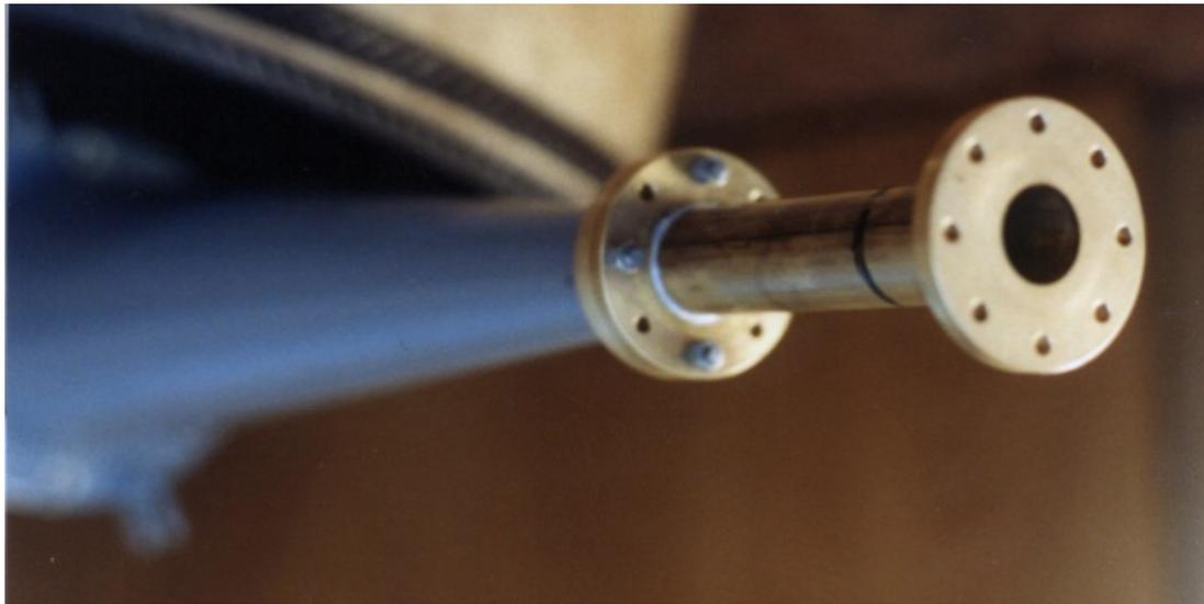
Der Fokuspunkt des Antennensystems liegt in dem Rundhulleiter aus Messing. Von der Lage her ist der Fokuspunkt der Antenne in der Ebene der Spiegeloberfläche. Der schwarze Strich auf dem Foto kennzeichnet diesen Punkt.
