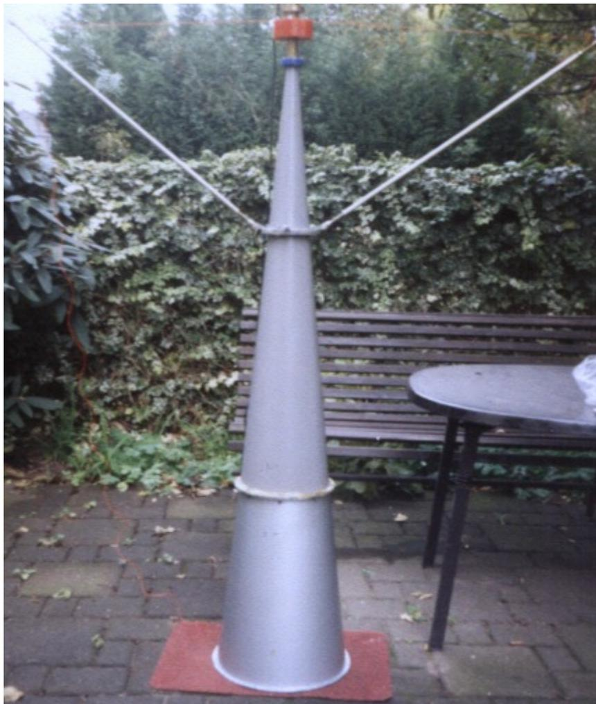
Je nach Anzahl der verwendeten Trichterelemente ist es möglich das System auf unterschiedliche Frequenzen zu optimieren. Mit diesem ersten Trichterelement von 42cm erreicht man für 36GHz eine gute Ausleuchtung des Spiegels. Mit der ersten Erweiterung von 71cm Länge erreicht man bei 17GHz die optimale Ausleuchtung (Material Alu versilbert). Die zweite Erweiterung mit ca. 32cm, ist für den Betrieb auf 10GHz erforderlich.
