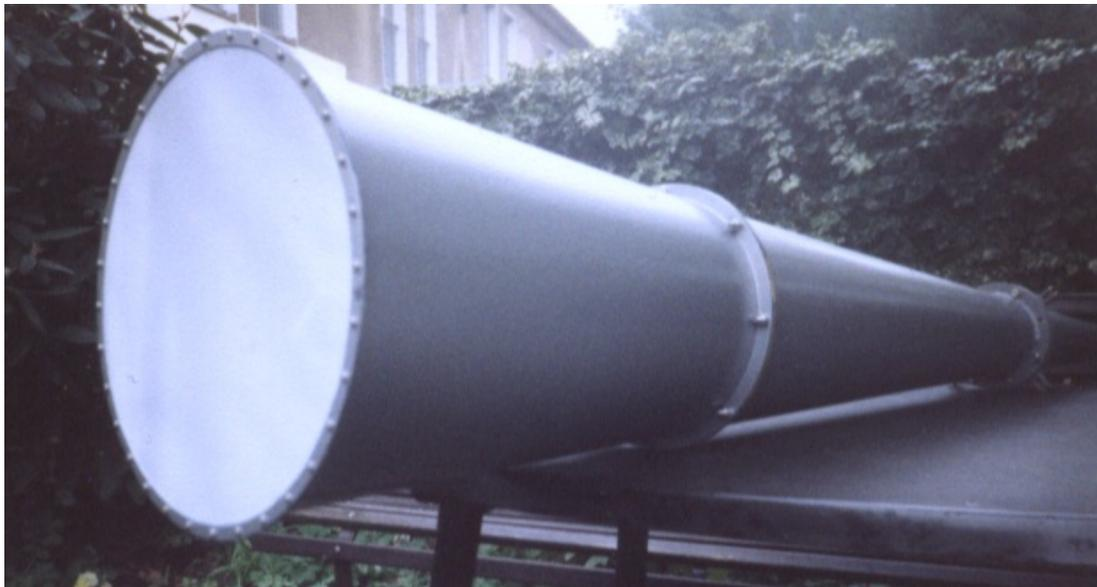
Am Ende des Trichters ist noch ein kleiner Anschlussflansch für einen 5mm Schlauch. Über diesen Schlauch erfolgt der Druckausgleich im Trichter. Der Schlauch endet in einer Patrone mit Trockensalz, sodass bei Luftdruckschwankung die Luft getrocknet wird.
