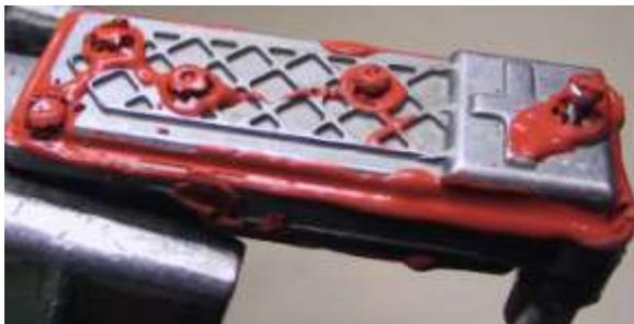
Vier kurze und eine lange Schraube entfernen. die hintere Schraube ist sehr lang
