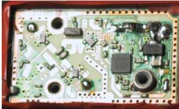
Mit dünnem Cu-Lackdraht eine Brücke vom Innenleiter zum  $51\Omega$  Widerstand einbauen.
