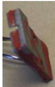
In den Deckel einen Schlitz für das Koax-Kabel feilen.
