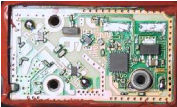
Den Quarz sowie ein Widerstand (0 Ohm) und zwei Kondensatoren auslöten.
