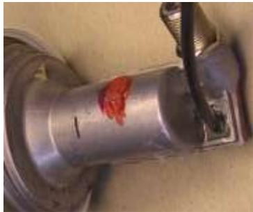
Später den Kabelausgang mit 2-Komponenten Kleber vergießen.
