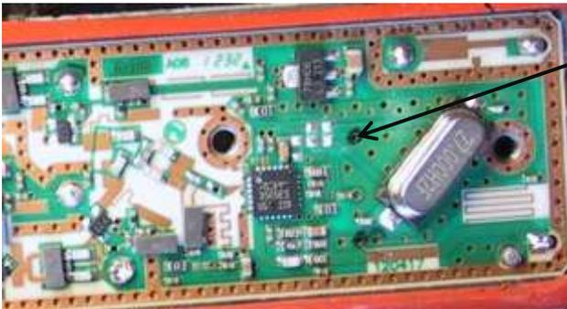
Durch diese Durchkontaktierung kann der Cu-Lackdraht nach unten geführt werden.
