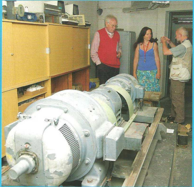
Der Rundgang durch den Astropeiler führte Prof. Dr.-Ing. Horst Pippert, Elke Fischer und Dipl.-Ing. Thomas Buchsteiner vom Förderverein (v. l.) unter anderem zur Amplidyne, dem Antrieb der gesamten Anlage. Links: Der 10-Meter-Spiegel aus dem Jahr 1966, mit dem unter anderem Messungen auf 10 GHz durchgeführt werden können.
