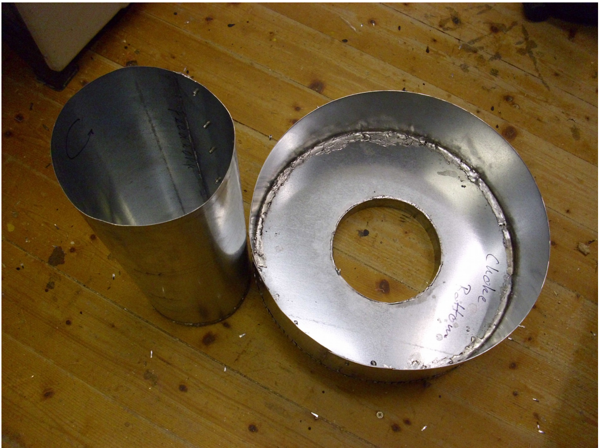
Beim Boden des Choke wird eine Kante nach oben, eine nach unten gekantet!
