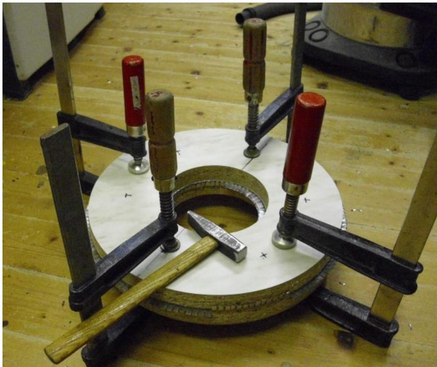
*Abb. 13: Biegevorgang mit Hilfe der Schablonen*
