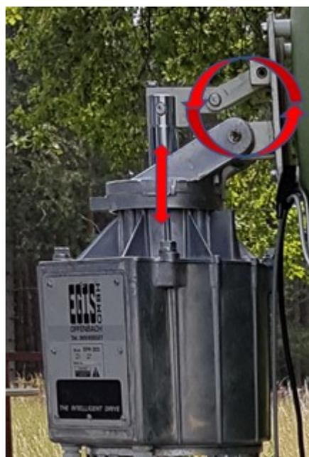
**Abb. 10:** Mechanik der Elevation
