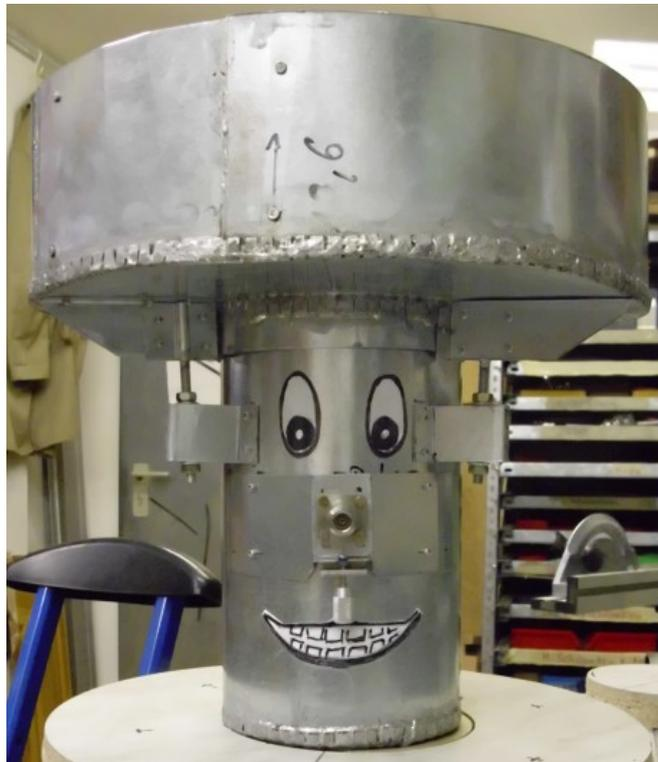
**Abb. 15:** Fertiges Feed Horn
