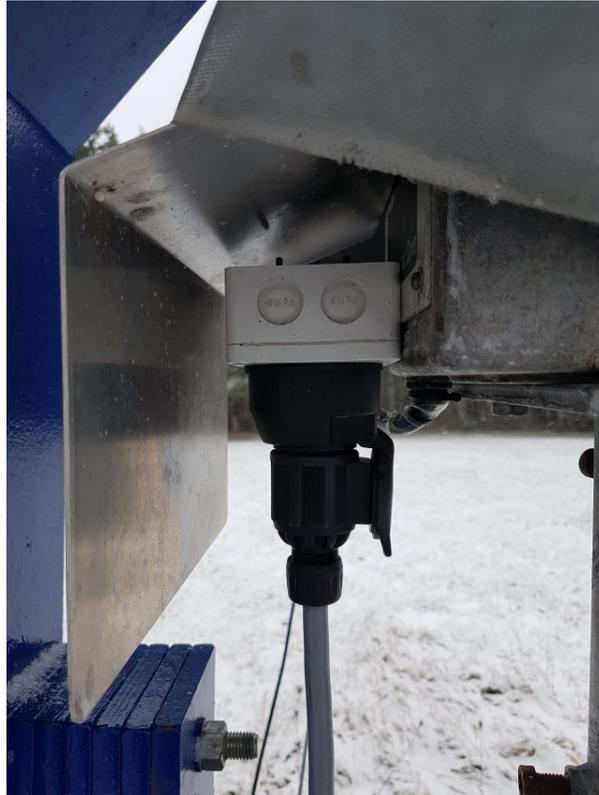
*Abb. 7: Anhänger-Steckverbindung am Rotor*
