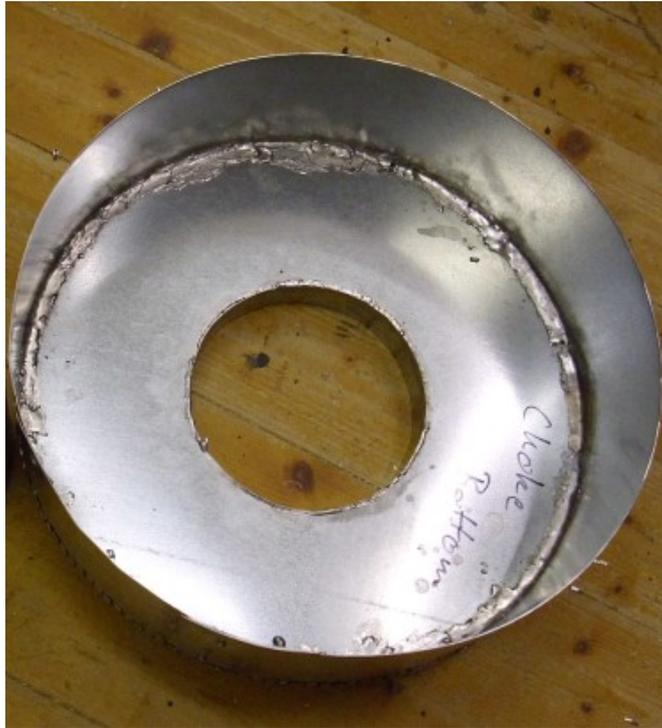
**Figure 14:** gelöteter Choke Ring
