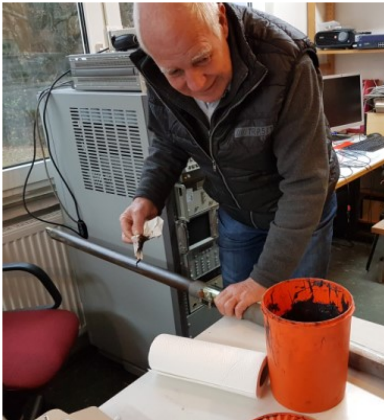
Abb. 8: Letzte Feinarbeit am Linearantrieb nach der Wartung
